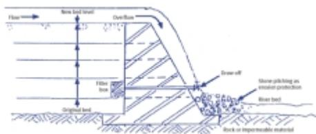
Coupe de profil d'un barrage en sable. En partie haute le nouveau lit de la rivière et le déversoir, en partie basse son lit initial, la chambre de filtration, le tuyau d'évacuation de l'eau et la protection du barrage contre l'érosion par des pierres.
