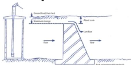
Vue de profil d'un barrage souterrain et de son puits. Source Water Aid
