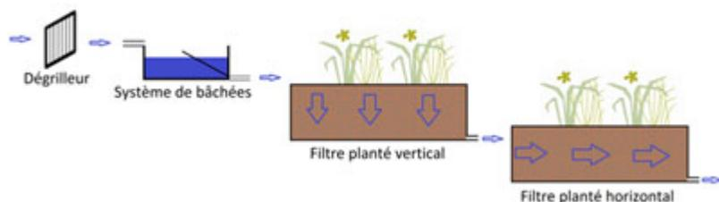
El filtro de flujo horizontal necesita una inclinación inferior a la del filtro de flujo vertical. **Un desnivel de dos a tres metros es suficiente** para esta instalación. Importa que el agua pase en primer lugar por el filtro verde de flujo vertical : es una etapa necesaria para evitar la obstrucción del filtro de flujo horizontal.
