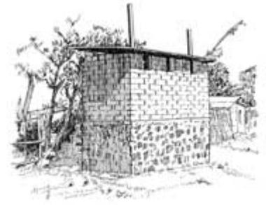
**El conducto debe ser recto** y situado en la vertical (desde el pozo, las moscas deben poder ver muy fácilmente la luz de la parte superior). Debe tener un diámetro de 10 a 15 cm si es de PVC u otro material liso o de 23 cm como mínimo si es de material rugoso (un poco menos hay mucho viento en la zona).
